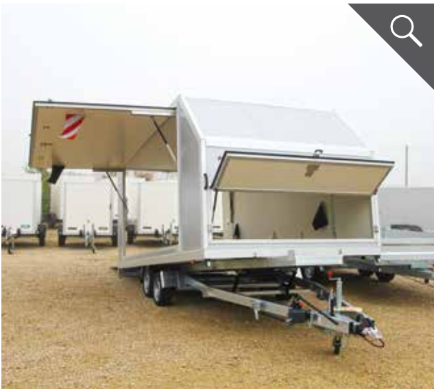
Klappen für die einfache Beladung des Fahrzeugs
