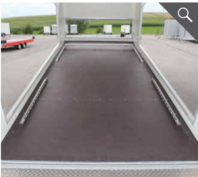
Integriertes Zurrsystem für eine einfache Ladungssicherung
