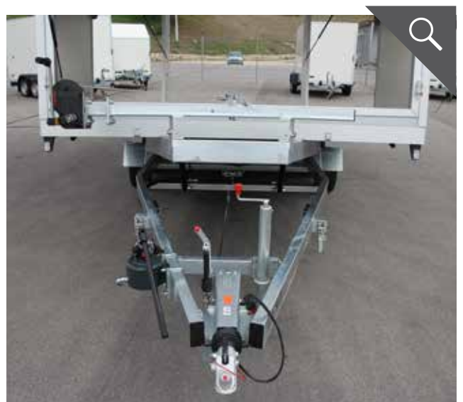
Fahrgestell aus verschweißter und feuerverzinkter Hohlprofilkonstruktion
